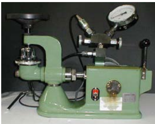
1. 破裂度計です。
